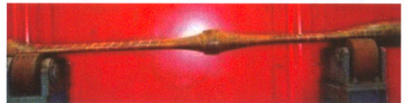
Figura 11 Validación del modelo de colapso de una tubería reforzada
